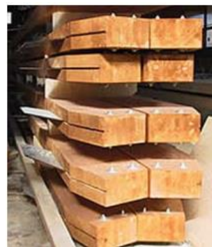
Taglio a misura, sagomature e forature per le connessioni metalliche
