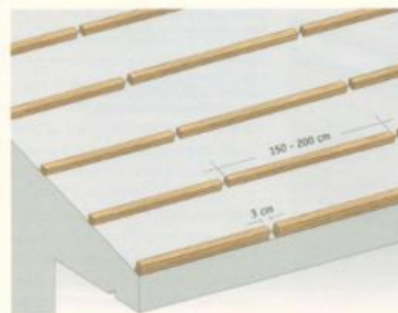
Interruzione dei supporti per favorire la micro-ventilazione del sottotegola.
