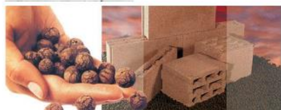
Argilla espansa per la produzione di blocchi di cls alleggerito (blocchi LECA – Light Expanded Clay Aggregate)
