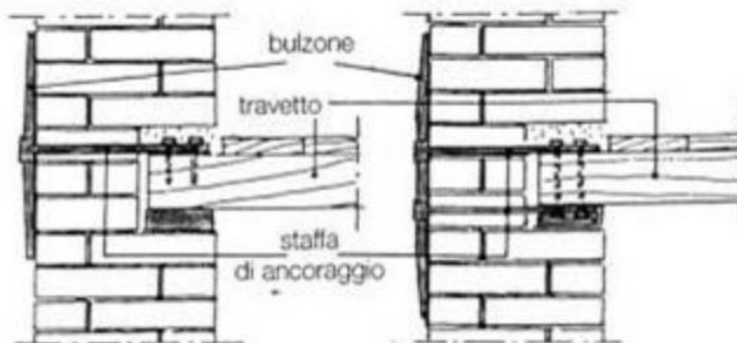
Concatenamento dei muri perimetrali mediante bulzoni.
