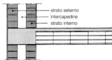
Disegno schematico di parete a cassa vuota.
