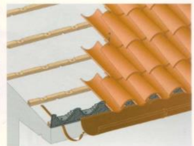
Supporto di gronda aerato con dispositivo anti-suction.
