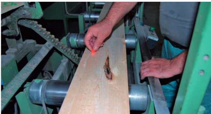
Figura 1.4. Individuazione dei difetti in una tavola destinata all'incollaggio di un elemento in legno lamellare; l'operatore segna la porzione che verrà scartata da una macchina dotata di controllo ottico
