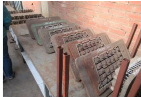
Tipi di filiere utilizzati per la produzione di pignatte laterizie (fornace Carena)
