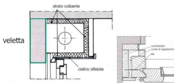
Fig. 15.105 Isolamento termico del cassonetto.
